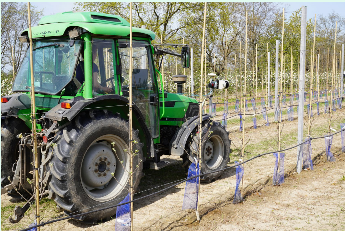
Abb. 06. Erfassung der Baumvolumina mit Laserscanner nach Pflanzung
